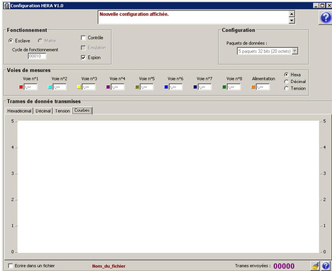
Commençons par prendre le contrôle de la carte en sélectionnant « Contrôle » dans le cadre « Fonctionnement » : le cadre « Contrôles Acquisition des mesures apparaît ».
