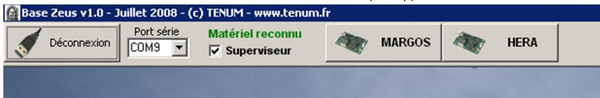
MARGOS : c'est le Module ARGOS qui comprend l'émetteur et permet sa configuration (fréquence, récurrence d'émission, etc.)
