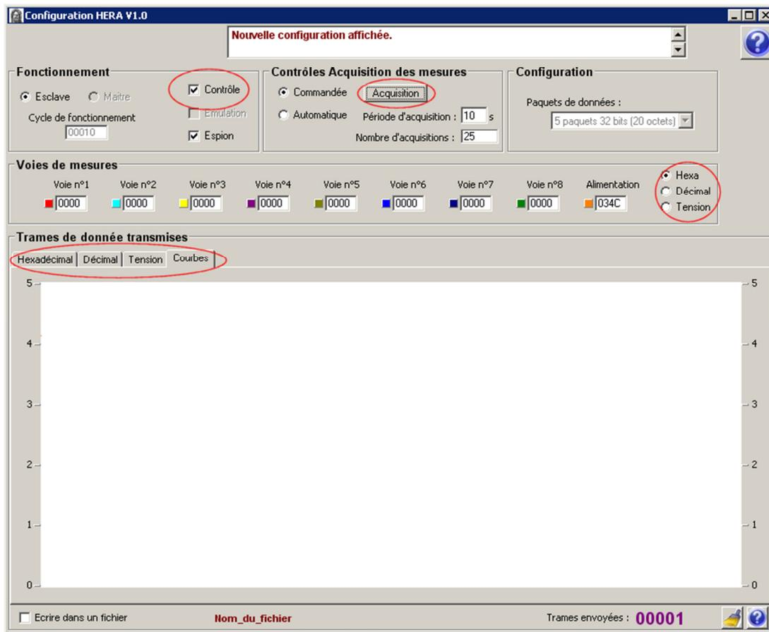
Dans le cadre « Voies de mesures » vous visualisez les résultats de la dernière acquisition sous différents formats : Hexa, décimal ou sous la forme de tension électrique. Ces données forment une trame qui sera intégrée dans le message ARGOS qui sera émis par le Module MARGOS.
